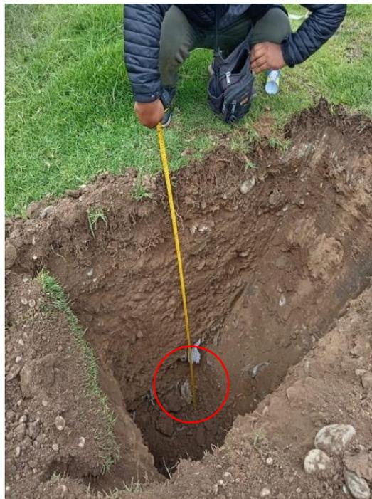
A partir de estos hallazgos, se recomendó al cliente que la calicata debía realizarse a una profundidad mínima de 3.00 metros. Se advirtió que no es adecuado realizar ensayos de capacidad portante sobre relleno no controlado, ya que este tipo de suelo no
